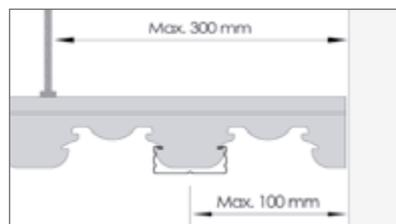
La primera suspensión se situará como máximo a **300 mm** y el primer rail F47 a una distancia máxima de **100 mm**.
